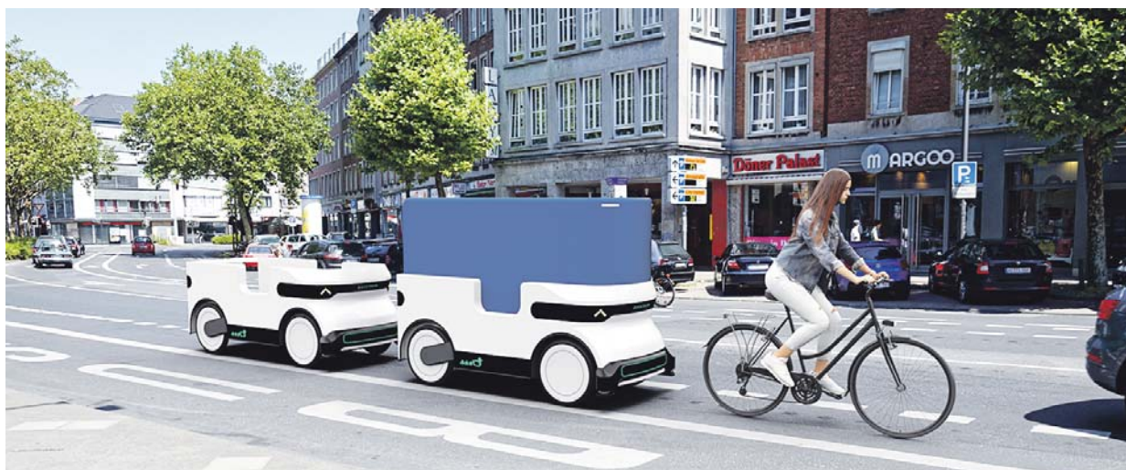
Der Duck Train vom Aachener Unternehmen Droiddrive folgt der Paketzustellerin auf Schritt und Pedaltritt. Das Gefährt besteht aus bis zu fünf autonomen Elektrofahrzeugen, ausgestattet mit Sensoren und künstlicher Intelligenz. Foto: Droiddrive GmbH
